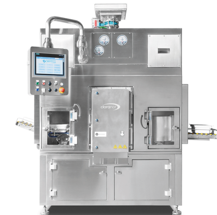
Steriline Pulsed Light Sterilizer : système robotisé utilisant la lumière pulsée pour la stérilisation des tubs en industrie pharmaceutique.
