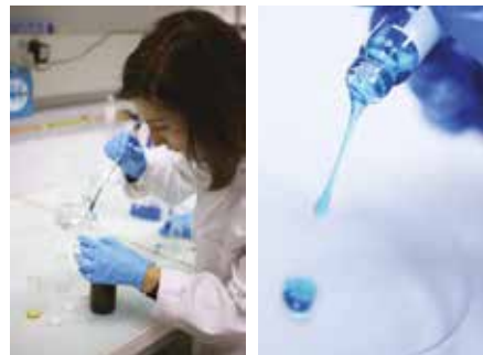
Le gel visqueux à base de polymère est photo-activé pour être solidifié rapidement. Il va agir comme une colle et, dans le corps humain, se résorber naturellement.
